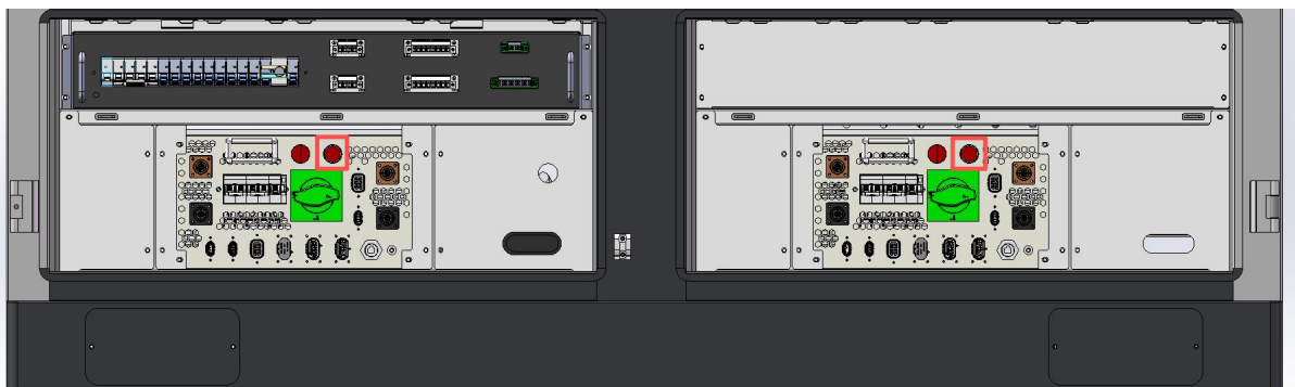
图4-4 高压箱电源开关
