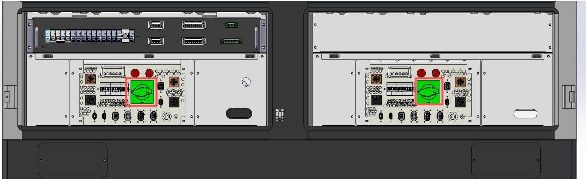
图4-2 高压箱断路器
