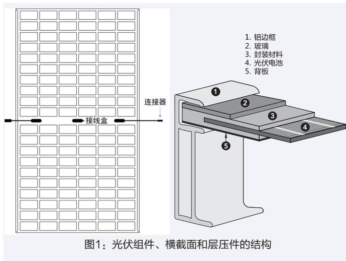
图1：光伏组件、横截面和层压件的结构
