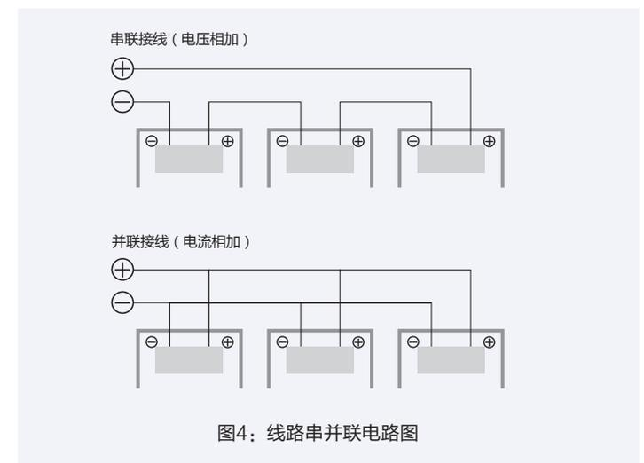
图4：线路串并联电路图
