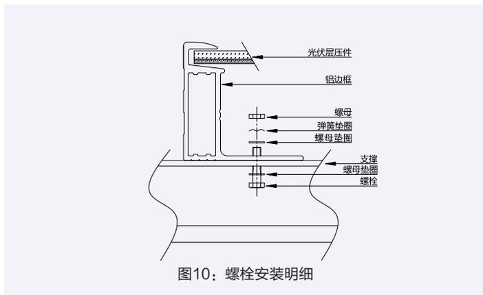
图10: 螺栓安装明细
