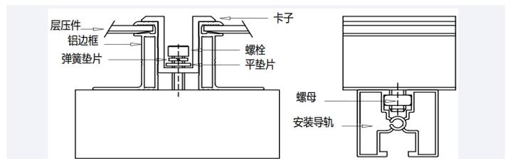
图12: 压块安装方式明细
