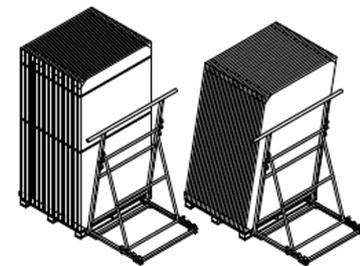
4、2人一起逐个搬运组件。如有剩余，将剩余组件用绑绳固定在防倒支架上，或者将其平放在托盘上(每个托盘不超过20块)。
