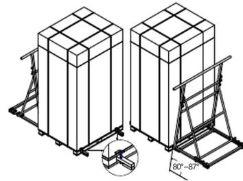
3、拆除打包带及纸箱（防倒支架一侧的纸箱可保留），仅剩余1至2根内部打包带，然后小心推动组件使其斜靠于防倒支架上。
