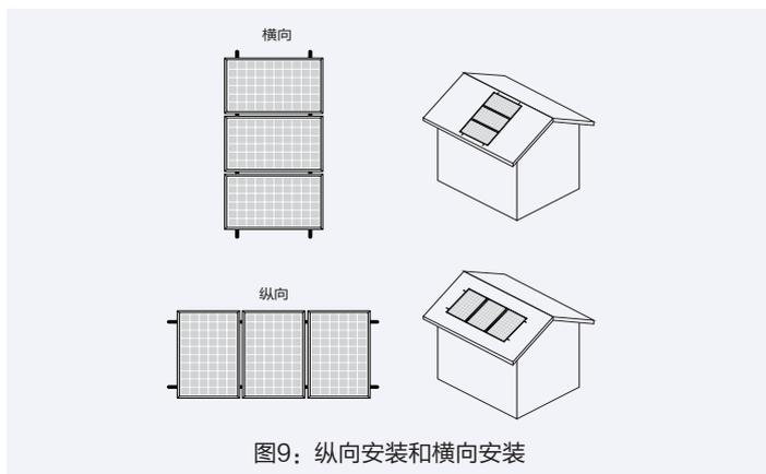
图9: 纵向安装和横向安装
