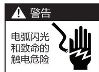
不正确的连接会引发电弧效应和电击。检查是否所有的电气连接处都被牢固的束紧，还要确保所有的连接器都被完全插紧。
