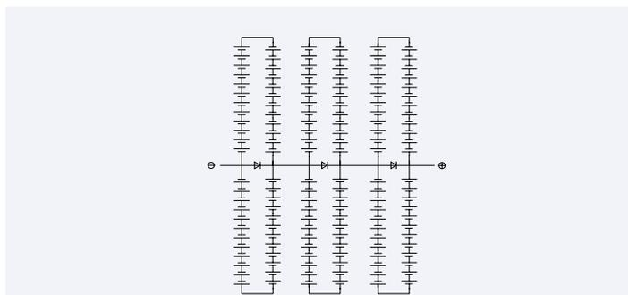
图6-1：电池串和旁路二极管的电路系统
