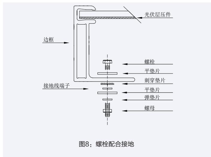
图8：螺栓配合接地
