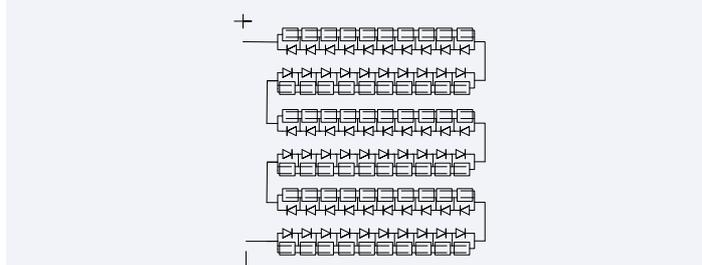
图6-2：电池片和旁路二极管的电路系统
